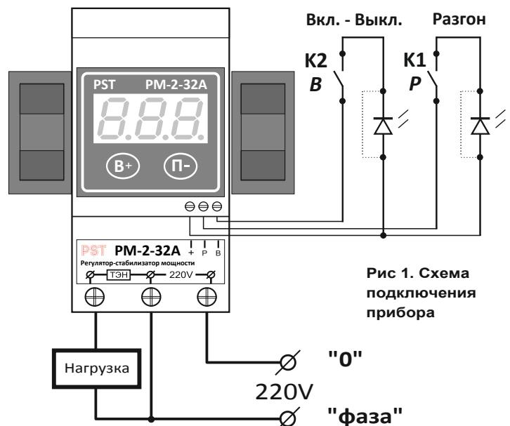
могут быть выключатель, тумблер, кнопка, автомат или свободные ("сухие") контакты терморегулятора. На клеммах **K1** и **K2** присутствует собственное управляющее постоянное (DC) низкое напряжение порядка 1,3 вольт, достаточно для включения подсветки внешнего или встроенного в кнопку светодиода с питанием 3 В. **Запрещается** подавать на контакты - «+», «Р», «В» какое-либо **дополнительное** питающее напряжение!
